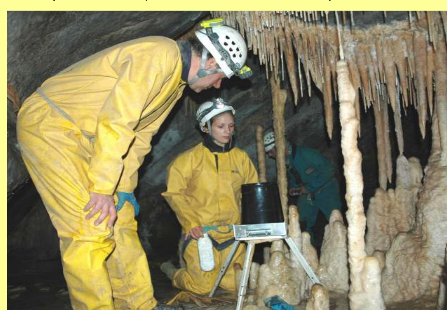
Fig.8: Mise en place d'un pluviomètre au sein de la grotte du Père Noël – Han-sur-Lesse
